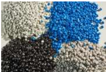
Mit «Bring Plastic back» wird der Haushalt-Kunststoff recycelt und zu Regranulat verarbeitet.
